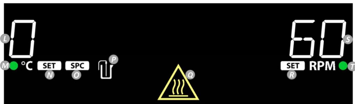
**L. Varmeelementets temperatur:** Endres til utvendig sondetemperatur når tilkoblet og P lyser.
