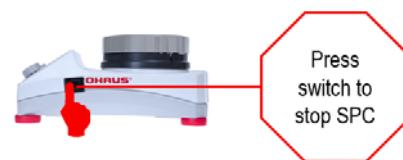
8. Uma vez que o dispositivo atingir a temperatura de calibração, o ícone SPC (O) e a configuração de aquecimento piscarão.
