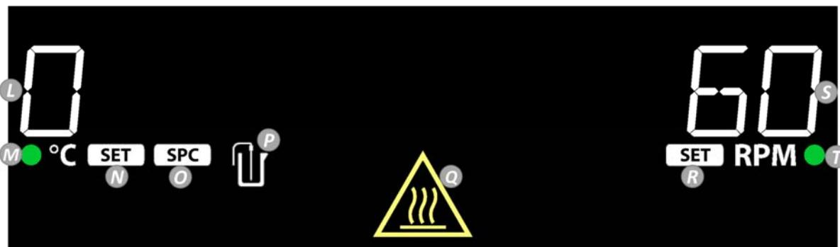
**L. Temperatura grzałki:** Przełącza się na zewnętrzną temperaturę sondy, gdy sonda jest podłączona, a P jest podświetlone.
