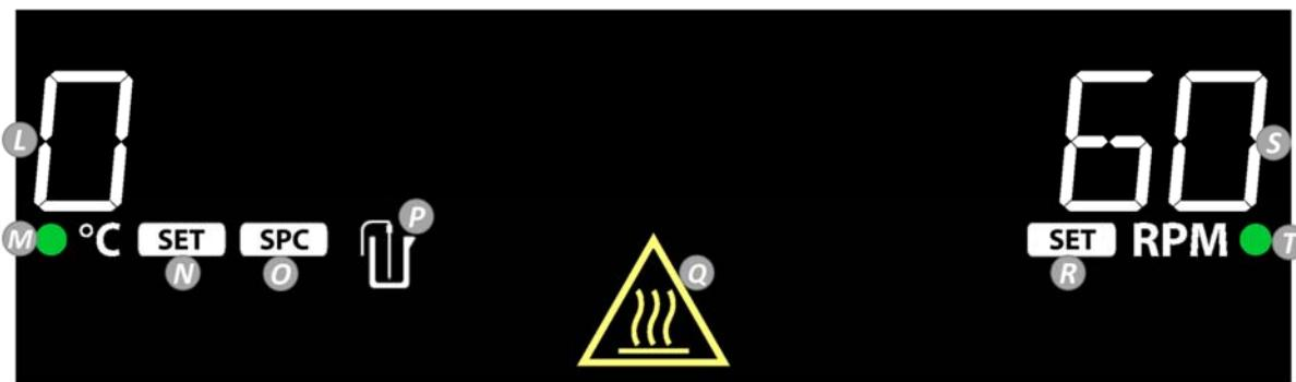
**L. Värme temperatur:** Byt till extern sondtemperatur när sonden är ansluten och P tänds.
