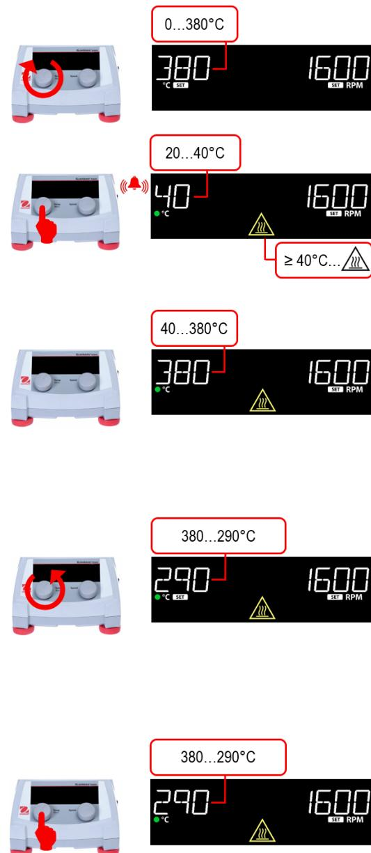
4. Um die Heizfunktion auszuschalten, halten Sie den linken Knopf (C) gedrückt, bis das Gerät einen Piepton abgibt und die Anzeige (M) der Heizfunktion verschwindet.
