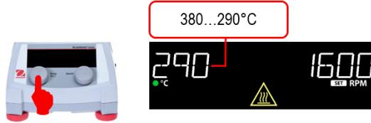
4. Para apagar el calentador, mantenga pulsada la ruleta izquierda (C) hasta que la unidad emita un pitido y desaparezca el indicador del calentador (M).
