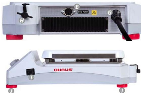
**A. Tela de exibição****B. Indicador de espera****C. Botão lado Esquerdo:** Controla o menu de temperatura e configurações**D. Botão lado Direito:** Controla a velocidade**E. Porta de sonda RTD externa****G. Cabo de alimentação****H. Botão com rosca para haste acessória****I. Interruptor de espera****J. Pés:** Não ajustável
