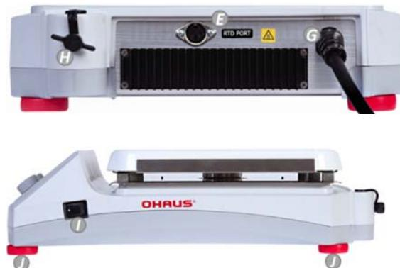
**A. Display skärm****B. Standby-indikator****C. Vänster reglage:** Kontrollerar temperatur- och inställningsmenyn**D. Höger reglage:** Kontrollerar hastighet**E. Extern RTD Sond Port****G. Nätkabel****H. Gängat vred för tillbehörsstång****I. Standby-omkopplare****J. Fötter:** Inte justerbar
