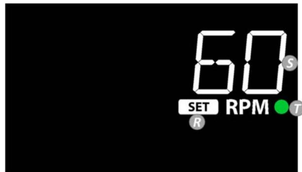
**R. Indicador de ajuste de velocidad:** se ilumina hasta que el agitador alcanza el ajuste de velocidad (S).
