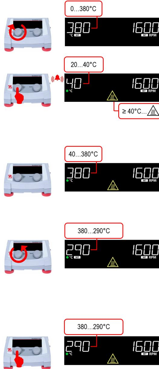
4. Per spegnere il riscaldatore, tenere premuta la manopola sinistra (C) fino a quando l'unità emette un segnale acustico e l'indicatore del riscaldatore (M) scompare.
