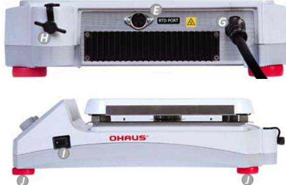
**A. Bildschirm anzeigen****B. Standby-Anzeige****C. Linker Drehknopf:** Steuert die Temperatur und das Einstellungsmenü**D. Rechter Knopf:** Steuert Geschwindigkeit**E. Externer RTD-Sondenanschluss****G. Netzkabel****H. Gewindeknopf für Zubehörstange****I. Standby-Schalter****J. Füße:** Nicht einstellbar
