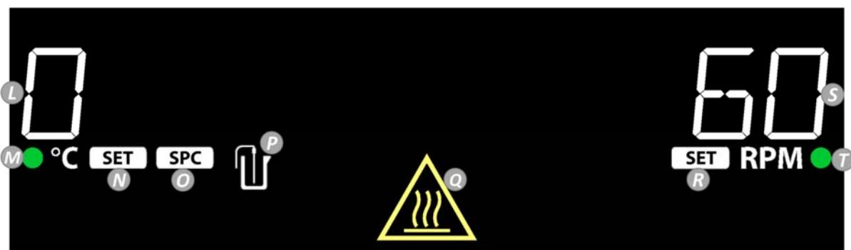
**L. VarmevarmerTemperatur:** Skifter til ekstern sondetemperatur, når sonden er tilsluttet, og P lyser.
